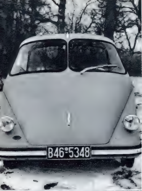
Das Dornier Delta, einmal von vorn, einmal von hinten. Es sieht kurioserweise vorn und hinten gleich aus, die Front ist nur an den Scheinwerfern und dem Scheibenwischer, das Heck an den Schlußlichtern zu erkennen. Das verbilligt natürlich die spätere Produktion des Fahrzeugs. Wenn man es dann vielleicht zweifarbig lackiert, wird es auch gleich gefälliger aussehen.
